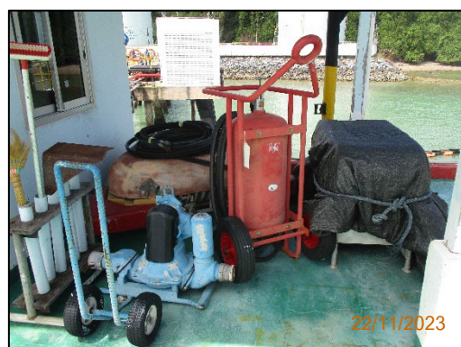
ภาพที่ 2-13 อุปกรณ์กำจัดคราบน้ำมัน เช่น BOOM และ SKIMMER บริเวณหน้าท่าเทียบเรือ
